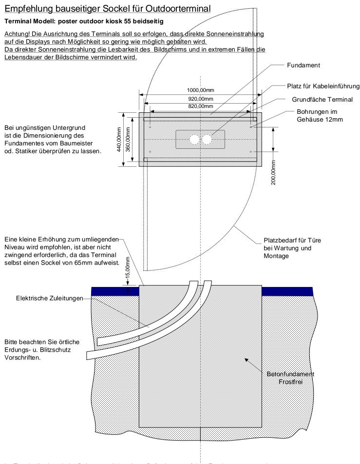
Im Terminalboden sind 4 Bohrungen (12mm) zur Befestigung auf dem Fundament vorgesehen. Im Lieferumfang sind 4 Stück Bolzenanker M10 x 95 (Edelstahl A4 mit ETA-Zulassung) zur Befestigung auf Beton enthalten.
