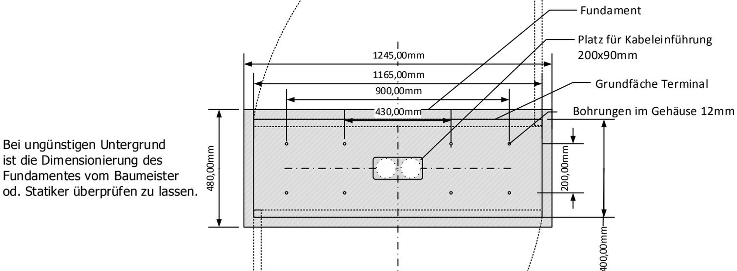
Bei ungünstigen Untergrund ist die Dimensionierung des Fundamentes vom Baumeister od. Statiker überprüfen zu lassen.
