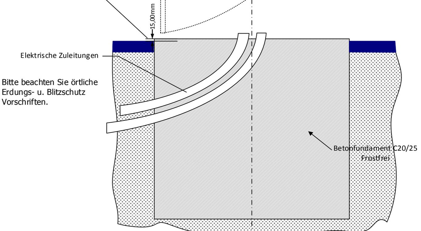
Im Terminalboden sind 8 Bohrungen (12mm) zur Befestigung auf dem Fundament vorgesehen. Im Lieferumfang sind 8 Stück Bolzenanker M10 x 95 (Edelstahl A4 mit ETA-Zulassung) zur Befestigung auf Beton enthalten.
